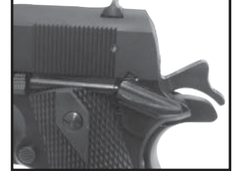
Fig. 8 Manuelle Sicherung in FEUER-Position
