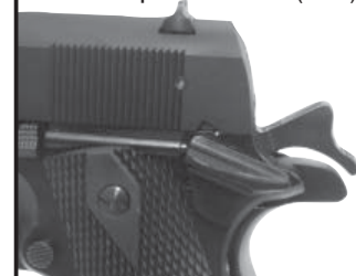
fig. 8 Sûreté manuelle en position de tir (FIRE)
